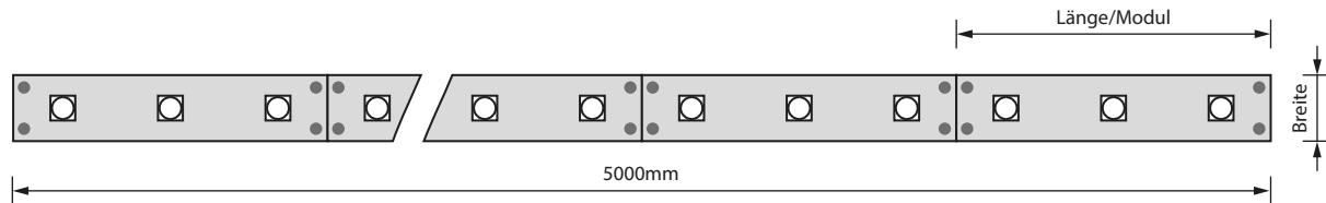
Anschlusschema flexLED-Platinenketten: Die gesamte Länge darf 5000mm nicht überschreiten. Wenn 5000mm überschritten werden, muss eine neue Zuleitung vom Konverter installiert oder ein neuer Konverter gesetzt werden.
