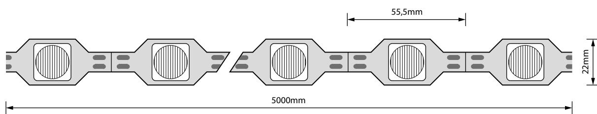
Anschlusschema flexLED Edge-Light Zargenmodule: Die gesamte Länge darf 5000mm nicht überschreiten. Wenn 5000mm überschritten werden, muss eine neue Zuleitung vom Konverter installiert oder ein neuer Konverter gesetzt werden.
