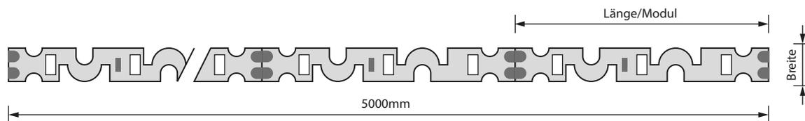
Anschlussschema flexLED-Platinenketten: Die gesamte Länge darf 5000mm nicht überschreiten. Wenn 5000mm überschritten werden, muss eine neue Zuleitung vom Konverter installiert oder ein neuer Konverter gesetzt werden.
