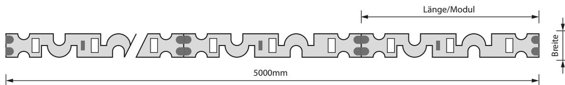
Anschlusschema flexLED-Platinenketten: Die gesamte Länge darf 5000mm nicht überschreiten. Wenn 5000mm überschritten werden, muss eine neue Zuleitung vom Konverter installiert oder ein neuer Konverter gesetzt werden.
