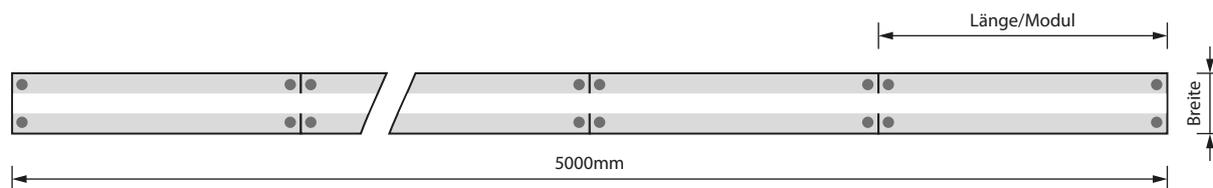
Anschlussschema flexCOB-Platinenketten: Die gesamte Länge darf 5000mm nicht überschreiten. Wenn 5000mm überschritten werden, muss eine neue Zuleitung vom Konverter installiert oder ein neuer Konverter gesetzt werden.
