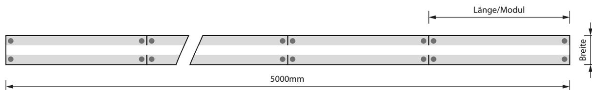
Anschlussschema flexCOB-Platinenketten: Die gesamte Länge darf 5000mm nicht überschreiten. Wenn 5000mm überschritten werden, muss eine neue Zuleitung vom Konverter installiert oder ein neuer Konverter gesetzt werden.
