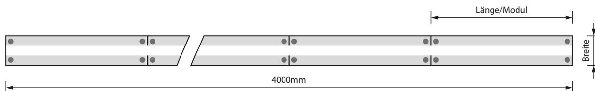
Anschlussschema flexCOB-Platinenketten: Die gesamte Länge darf 4000mm nicht überschreiten. Wenn 4000mm überschritten werden, muss eine neue Zuleitung vom Konverter installiert oder ein neuer Konverter gesetzt werden.
