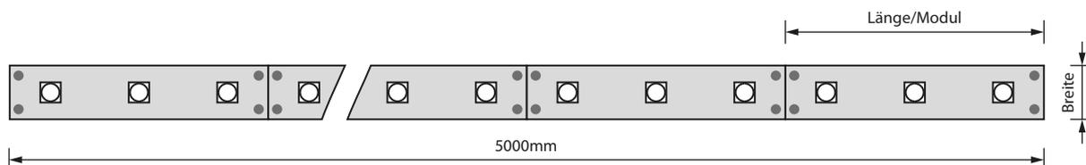
Anschlussschema flexLED-Platinenkette: Die gesamte Länge darf 5000mm nicht überschreiten. Wenn 5000mm überschritten werden, muss eine neue Zuleitung vom Konverter installiert oder ein neuer Konverter gesetzt werden.
