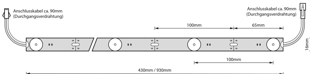
Diese LED-Rigid Bars sind speziell für Leuchtkästen ab 50mm (für den Innenbereich) entwickelt. Die Installation erfolgt schnell und einfach dank selbstklebender vollflächiger Rückseite und Durchgangsverdrahtung.
