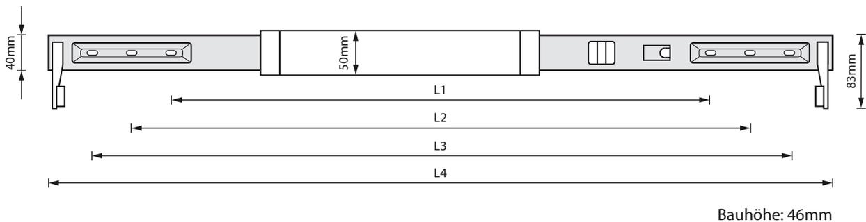
Das EVG entspricht der IP 67 Norm, d. h. für Außenmontage unter allen gängigen Wetterbedingungen geeignet!
